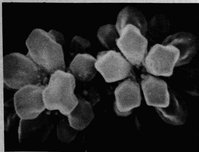
Fig. 7 Cuasicristales de aluminio y manganeso. Foto tomada con Microscopio de Barrido. Cortesía de la Dra. Agnes Csandy
